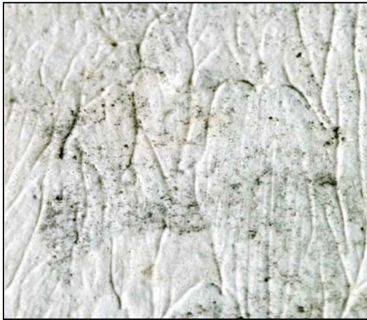
Bild 5: SS2 auf PB nach 18-monatiger Inkubation – „Schwärzepilze“
